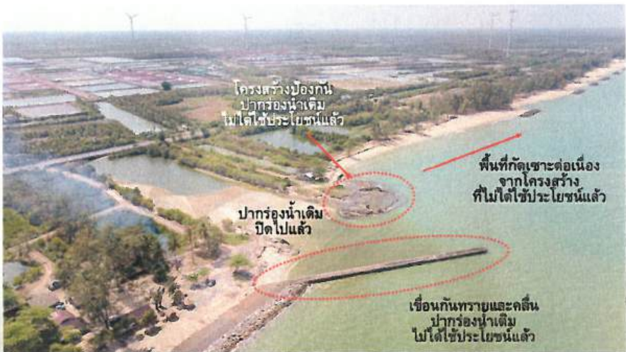
โครงสร้างปากร่องน้ำเดิมที่ไม่ได้ใช้ประโยชน์แล้ว ขนาบนาถ จ.นครศรีธรรมราช
