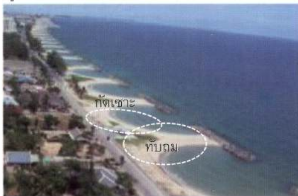
รูปที่ 5 ผลกระทบของเขื่อนกันคลื่น ณ หาดแสงจันทร์ จ.ระยอง
